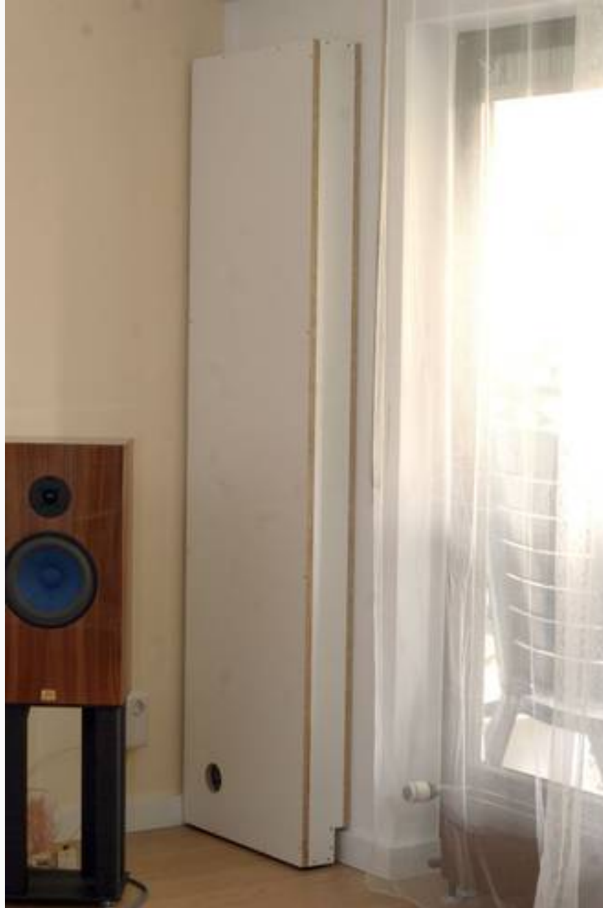
Derart flach und hoch, wird der 110-Liter- Resonator hinter einer Gardine unsichtbar
