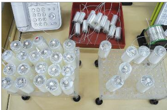
Im letzten Arbeitsschritt erhalten die Anschlussseiten der Silber-Kondensatoren einen sichernden und dauerhaft dichten Abschluss aus Epoxydharz
