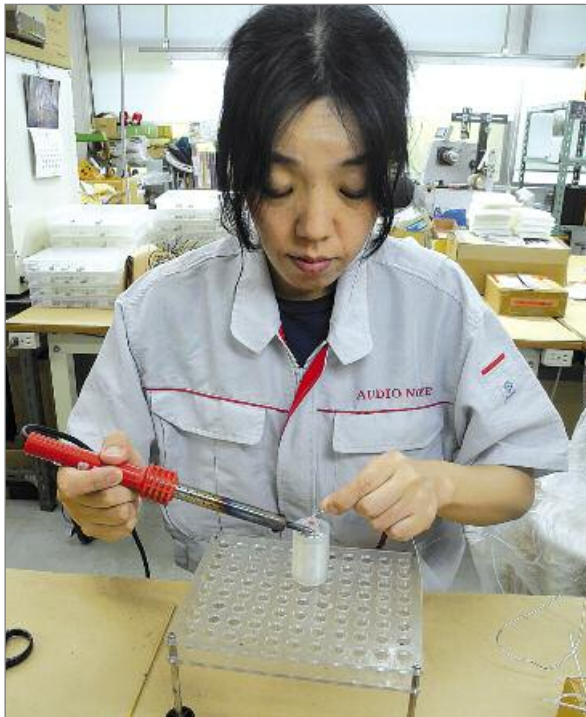
Fast fertig: Nach der Wicklung und Ummantelung der Silber-Kondensatoren werden die Silber-Anschlussdrähte angelötet
