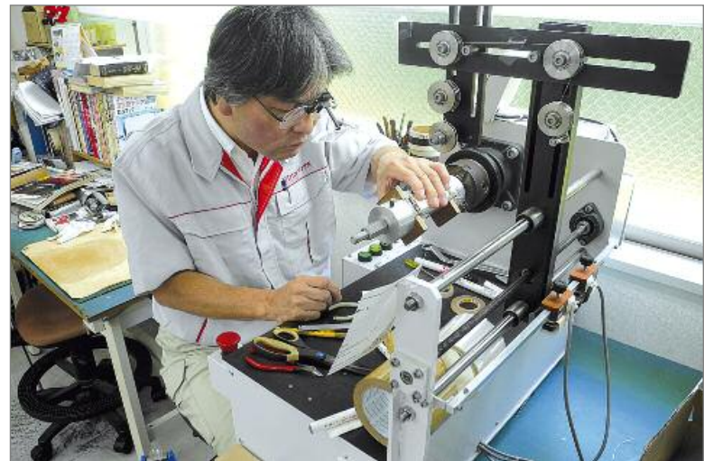
Hoch konzentriert: Hier werden gerade die Ausgangsübertrager für die neue Gakuoh II Endstufe gewickelt, immer zwei symmetrierte Paare pro Seite
